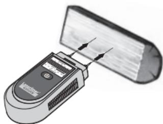
El punto a medir no debe estar tratado ni presentar nudos, suciedad o resina. No se deben realizar mediciones en los lados frontales pues la madera aquí se seca muy rápido y podría dar resultados falsos de medición.
